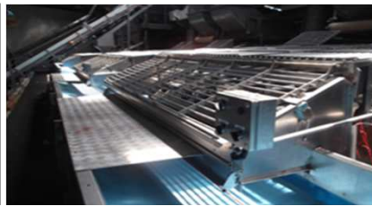
Sécurisation des effeuilleuses
