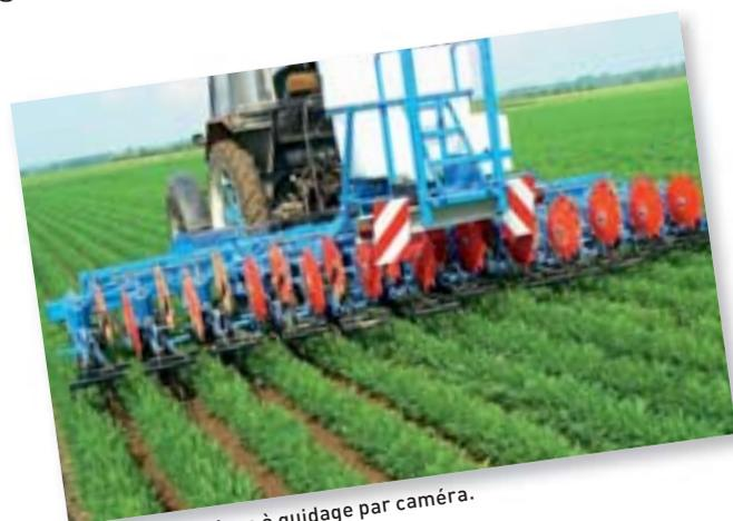
Bineuse mécanique à guidage par caméra.
